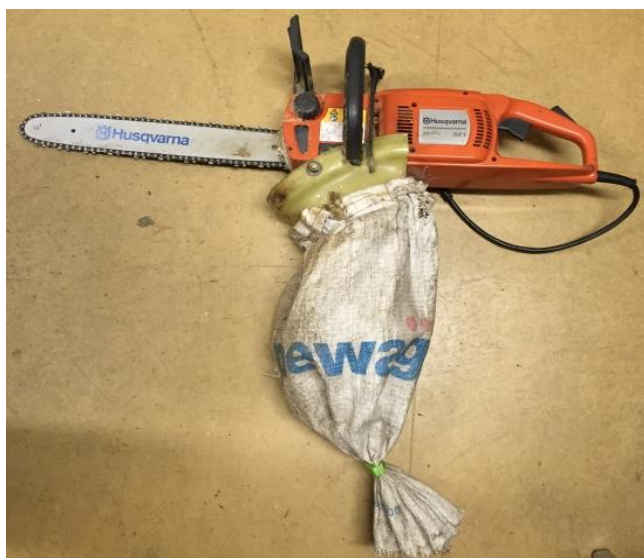
Снимка 17: Моторен трион с устройство за събиране на проби
